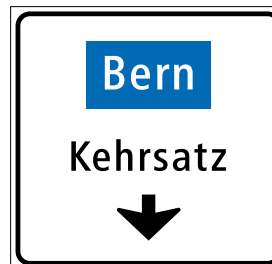
4.42 Panneau de présélection au-dessus d'une voie de circulation sur route secondaire (art. 53)
